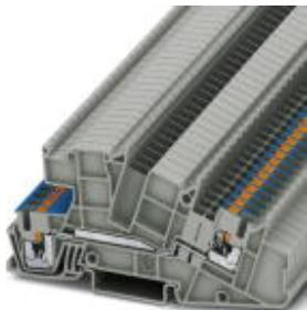
Монтажная клемма, Зажимы Push-in, сечение: 0,14 мм<sup>2</sup> - 4 мм<sup>2</sup>, AWG: 26 - 12, ширина: 5,2 мм, цвет: серый/синий, тип монтажа: NS 35/7,5, NS 35/15
