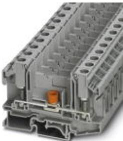
Клемма с размыкателем , с винтами для крепления контрольного штекера, номинальное напряжение: 1000 В, номинальный ток: 41 А, тип подключения: Болтовые клеммы, длина: 79,2 мм, ширина: 11 мм, цвет: серый, монтаж: NS 35/7,5, NS 35/15, NS 32, номинальное напряжение: 1000 В
