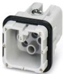
Модуль для контактов, полюсов: 7+PE, размер: D7, количество точек подключения на полюс: 1, Штифт, Обжим, 250 В, 10 А, 0,14 мм<sup>2</sup> ... 2,5 мм<sup>2</sup>, только для пластиковых корпусов
