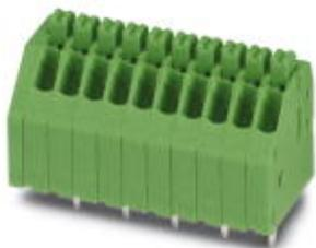
Клеммы для печатной платы, номинальный ток: 2 А, номинальное напряжение: 250 В, размер шага: 2,5 мм, полюсов: 4, тип подключения: Пружинные зажимы Push-in, монтаж: Пайка волной припоя, направление подключения, проводник/печатная плата: 45°, цвет: зеленый. Смещенные выводы под пайку, двухрядн.
