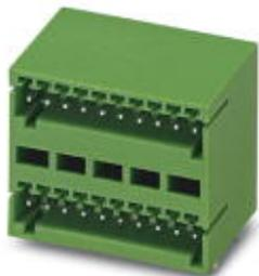
Корпусная часть для печатных плат, номинальный ток: 4 А, расчетное напряжение (III/2): 160 В, полюсов: 3, размер шага: 2,5 мм, цвет: зеленый, поверхность контакта: олово, монтаж: Пайка волной припоя
