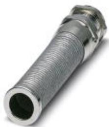
Кабельный ввод, материал резьбового соединения: латунь, никелированный, применение: Стандартн., наружный диаметр кабеля 6 мм ... 13 мм, экранировка: нет, резьба соединительной части: M20 x 1,5, цвет: серебристый, с защитой от излома, с уплотнительным кольцом
