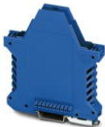
Установочный корпус, длина: 99 мм, с вентиляционными отверстиями, Нижняя часть корпуса, поперечное соединение: встроенный шинный соединитель, цвет: синий, ширина: 17,5 мм, кол-во контактов поперечного соединителя: 10
