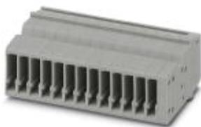
Соединитель COMBI, номинальное напряжение: 500 В, номинальный ток: 17,5 А, тип подключения: Зажимы Push-in, количество точек подсоединения: 1, полюсов: 13, сечение: 0,14 мм<sup>2</sup> - 1,5 мм<sup>2</sup>, AWG: 26 - 14, ширина: 45,5 мм, высота: 17,8 мм, цвет: серый
