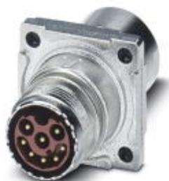
Проходная деталь, Крепление SPEEDCON, M17, полюсов: 17, тип контактов: Штифт, Обжим, Плоское уплотнение, 4x Ø 3,2, экранирован.: есть, размер фланца: 25,75 мм x 25,75 мм, диапазон диаметра кабеля: 3,5 мм ... 5,5 мм
