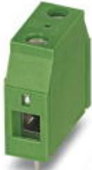
Клеммы для печатной платы, номинальный ток: 41 А, номинальное напряжение: 320 В, размер шага: 7,5 мм, полюсов: 7, тип подключения: Винтовой зажим с натяжной гильзой, монтаж: Пайка волной припоя, направление подключения, проводник/печатная плата: 0 °
