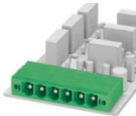
Корпусная часть для печатных плат, номинальный ток: 76 A, расчетное напряжение (III/2): 1000 В, полюсов: 8, размер шага: 10,16 мм, цвет: зеленый, поверхность контакта: Серебро, монтаж: Пайка волной припоя, Номинальный ток 76 A действителен только для случаев применения с разъемами серии РС 16. При использовании разъемов РС 6 ток составляет 41 A (50 A согласно UL).
