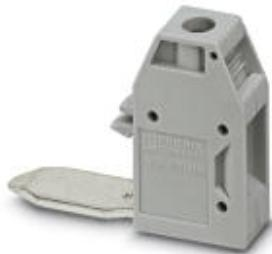
Клеммы-отводы, номинальное напряжение: 1000 В, номинальный ток: 57 А, тип подключения: Винтовые зажимы, количество точек подсоединения: 1, сечение: 0,5 мм<sup>2</sup> - 10 мм<sup>2</sup>, AWG: 20 - 8, ширина: 10,2 мм, высота: 34,7 мм, цвет: серый, тип монтажа: на основной элемент
