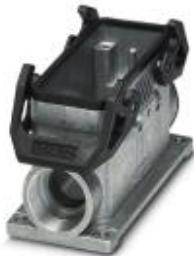
Приборный корпус B16, с двумя защелками, материал: Из алюминия, методом литья под давлением, стойкий к морской воде, длина кабеля: 2, боковое, высота: 68 мм, кабельный ввод: без, патрубок: Нет, 2x Pg21, Стандартн.
