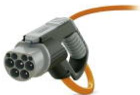
Зарядный кабель перем. тока с автомобильным зарядным штекером, без разъема, без защитного колпачка, Designlinie 1, GB/T, GB/T 20234.2, 32 A / 250 В (AC), тип конструкции D-Line, кабель: 7 м, оранжевый, прямой, ВНИМАНИЕ: могут потребоваться кабельные принадлежности., поверхность сопряжения: серый, область захвата: серый
