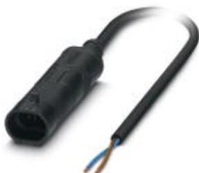
Кабель для датчика / исполнительного элемента, 2-полюсн., PUR без галогенов, темно-серый RAL 7021, Штекеры прямое Superseal Зажимное соединение, к свободный конец, длина кабеля: 3 м
