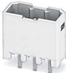
Корпусная часть для печатных плат, номинальный ток: 6 A, расчетное напряжение (III/2): 160 В, полюсов: 2, размер шага: 2,5 мм, цвет: белый, поверхность контакта: олово, монтаж: THR пайка
