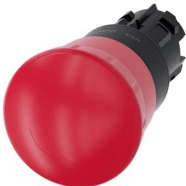
Грибовидная кнопка аварийного останова, 22 мм, кругл., пластмасса, цвет: красный, 40 мм, положительная блокировка, согласно DIN EN ISO 13850, поворотный расцепной механизм
