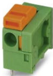
Клеммы для печатной платы, номинальный ток: 17,5 А, номинальное напряжение: 630 В, размер шага: 7,62 мм, полюсов: 1, тип подключения: Пружинные зажимы Push-in, монтаж: Пайка волной припоя, направление подключения, проводник/печатная плата: 0 °, цвет: зеленый. Конечная клемма для терминирования индивидуально подобранных блоков.
