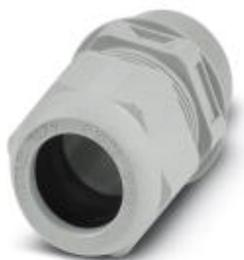
Кабельный ввод, материал резьбового соединения: PA, наружный диаметр кабеля 16 мм ... 28 мм, экранировка: нет, резьба соединительной части: M40 x 1,5, цвет: светло-серый, RAL 7035
