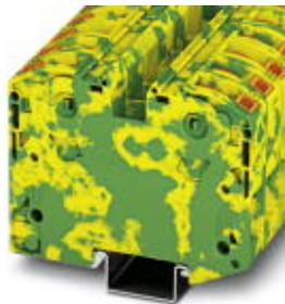
Клемма защитного провода, тип подключения: Зажим Power-Tight, количество точек подсоединения: 2, сечение: 2,5 мм<sup>2</sup> - 35 мм<sup>2</sup>, AWG: 12 - 2, ширина: 16 мм, цвет: желто-зел., тип монтажа: NS 35/15
