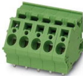
Клеммы для печатной платы, номинальный ток: 32 А, номинальное напряжение: 630 В, размер шага: 7,5 мм, полюсов: 1, тип подключения: Пружинный зажим, монтаж: Пайка волной припоя, направление подключения, проводник/печатная плата: 45 °, цвет: желто-зеленый
