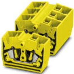
Проходная мини-клемма, номинальное напряжение: 800 В, номинальный ток: 24 А, тип подключения: Пружинный зажим, количество точек подсоединения: 4, сечение: 0,08 мм<sup>2</sup> - 4 мм<sup>2</sup>, AWG: 28 - 12, ширина: 10,4 мм, высота: 22 мм, цвет: желтый, тип монтажа: Прямой монтаж при помощи фланца
