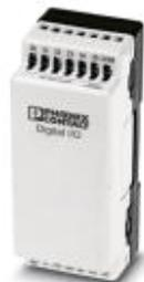
Модуль расширения ввода-вывода для применения с базовым модулем Nanoline на 24 В DC. Имеет три канала цифрового ввода и четыре канала вывода с реле на 5 А. К базовому модулю может быть подключено не более трех модулей расширения ввода-вывода.
