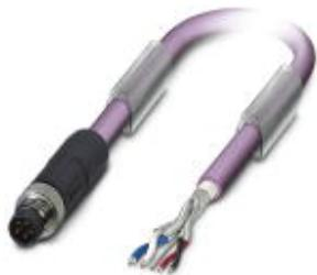
Системный кабель шины, CANopen®, DeviceNet™, 5-полюсн., PUR без галогенов, фиолетовый RAL 4001, экранирован., Штекеры прямое M8, к свободный конец, длина кабеля: 15 м, Соединитель неэкранированный
