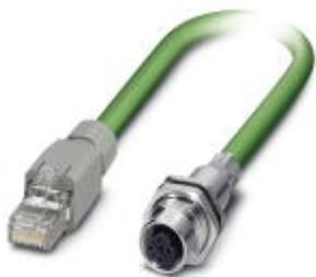
Готовый кабель PROFINET, CAT5e, экранированный, четверка звездообразной скрутки, AWG 22, подходит для буксируемых цепей (7-проводочный), RAL 6018 (желто-зеленый), с разъема RJ45/IP20 на встраиваемую розетку M12, монтаж с задней части стенки / резьбовое крепление с M16, прямая разводка, длина 2 м
