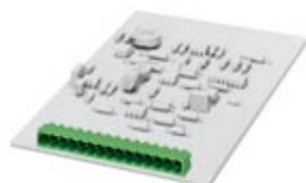
Корпусная часть для печатных плат, номинальный ток: 12 А, расчетное напряжение (III/2): 320 В, полюсов: 7, размер шага: 5 мм, цвет: зеленый, поверхность контакта: олово, монтаж: Пайка волной припоя
