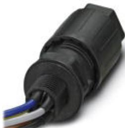
Проходная деталь QUICKON для взрывоопасных областей, кол-во контактов 4+PE, 1,0 мм<sup>2</sup>... 2,5 мм<sup>2</sup> / с гайкой QUICKON, черной, для кабеля диаметром 6 мм ... 11 мм, соединительная резьба M20 с 5 приваренными жилами 2,5 мм<sup>2</sup>, длиной 0,5 м, концы ровно обрезаны.
