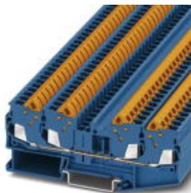
Проходные клеммы, номинальное напряжение: 800 В, номинальный ток: 24 А, тип подключения: Быстрое подключение, количество точек подсоединения: 4, сечение: 0,5 мм<sup>2</sup> - 2,5 мм<sup>2</sup>, AWG: 20 - 14, ширина: 6,2 мм, высота: 37,8 мм, цвет: синий, тип монтажа: NS 35/7,5, NS 35/7,5
