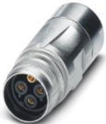
Переходные соединители, прямой, для стандартной блокировки и SPEEDCON, M17, полюсов: 5+PE, тип контактов: Розетка, Обжим, экранирован.: есть, диапазон диаметра кабеля: 5 мм ... 9,2 мм
