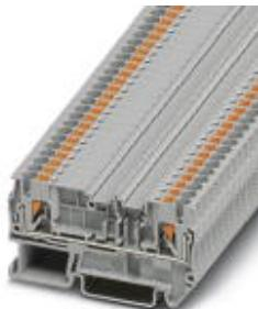
Проходные клеммы, номинальное напряжение: 400 В, номинальный ток: 24 А, тип подключения: Зажимы Push-in, количество точек подсоединения: 2, сечение: 0,14 мм<sup>2</sup> - 4 мм<sup>2</sup>, AWG: 26 - 12, ширина: 5,2 мм, цвет: серый, тип монтажа: NS 35/7,5, NS 35/15
