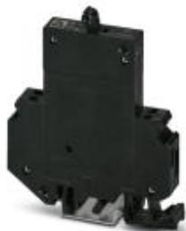
Термомагнитный защитный выключатель, полюсов: 1, тип подключения: Винтовые зажимы, сечение: 0,2 мм<sup>2</sup>- 6 мм<sup>2</sup>, AWG: 24 - 10, номинальный ток: 10 А, ширина: 12,5 мм, тип предохранителя: Автомат, тип монтажа: Монтажная рейка: 35 мм, Цвет: черный
