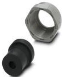
Резьбовой сальник Pg16 с частично нарезанной резьбой, пластмассовый, в комплекте с резиновым уплотнением с одним отверстием и прижимной винтовой деталью, для корпусов исполнения 1, кабель (мм) 6,5-9,5
