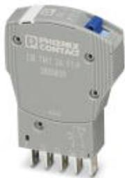
Термомагнитный защитный выключатель, 1-полюсный, характеристика срабатывания F1 (быстродействующий), 1 переключающий контакт, штекер для базового элемента.
