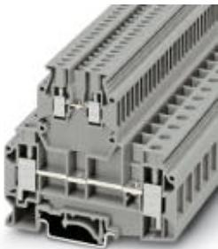
Двухъярусные клеммы, тип подключения: Винтовые зажимы, сечение: 0,5 мм<sup>2</sup> - 16 мм<sup>2</sup>, AWG: 20 - 6, ширина: 10,2 мм, цвет: серый, тип монтажа: NS 35/7,5, NS 35/15, NS 32
