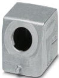
Сальниковый корпус B6, Крепление производится одной защелкой, материал: Из алюминия, методом литья под давлением, стойкий к морской воде, длина кабеля: 1, боковое, высота: 52 мм, кабельный ввод: без, патрубков: Нет, 1x M25, Стандартн.
