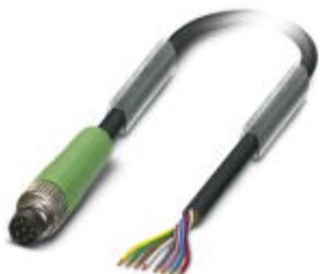
Кабель для датчика / исполнительного элемента, 8-полюсн., PUR без галогенов, темно-серый RAL 7021, Штекеры прямое M8, к свободный конец, длина кабеля: 10 м
