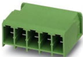
Корпусная часть для печатных плат, номинальный ток: 20 А, расчетное напряжение (III/2): 630 В, полюсов: 3, размер шага: 7,62 мм, цвет: кремевый белый, поверхность контакта: олово, монтаж: Пайка волной припоя
