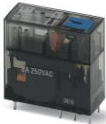
Вставное миниатюрное реле, с силовым контактом, 2 перекл. контакта, кнопка тестирования, мех. индикатор коммутации, полярность: биполярное, входное напряжение 24 В DC
