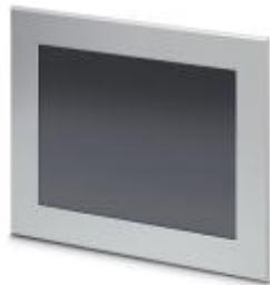
Сенсорная панель с TFT-дисплеем 38,1 см / 15"-дисплей (аналогово-резистивные (полиэфир)), 1024 x 768 Пиксел (XGA), 65536 цветов, Arm9™, 200 МГц, 2x USB Host 2.0, 1x COM (RS-232/485), 1x Ethernet (10/100 Мбит/с), RJ45, Windows CE 5.0 и прикладное ПО: TSvisRT. (шинная система: без)
