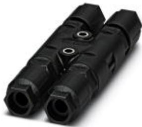
Н-разветвитель, Тип подключения QUICKON, полюсов: 3+PE, 1 мм<sup>2</sup> ... 2,5 мм<sup>2</sup>, 690 В, 20 А, черный, с четырьмя гайками QUICKON, диапазон диаметра кабеля: 9 мм ... 14 мм
