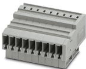
Соединитель COMBI, номинальное напряжение: 800 В, номинальный ток: 32 А, тип подключения: Пружинный зажим, количество точек подсоединения: 2, полюсов: 9, сечение: 0,08 мм<sup>2</sup> - 6 мм<sup>2</sup>, AWG: 28 - 10, ширина: 55,8 мм, высота: 31 мм, цвет: серый, тип монтажа: на монтажную пластину
