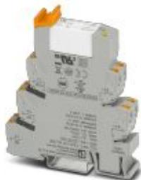
PLC-INTERFACE для ж/д транспорта и высокого тока длительной напр., состоит из основной клеммы с зажимом push-in и вставного мини-реле, диапазон:  $0,7 \times U_N$  до  $1,25 \times U_N$ , класс температуры TX:  $-40^\circ\text{C}$  до  $+70^\circ\text{C}$ , 1 переключающий контакт, входное напряжение 72 В DC
