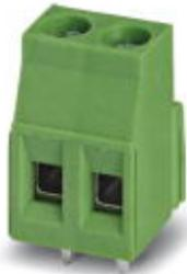
Клеммы для печатной платы, номинальный ток: 24 A, номинальное напряжение: 400 В, размер шага: 5 мм, полюсов: 5, тип подключения: Винтовой зажим с натяжной гильзой, монтаж: Пайка волной припоя, направление подключения, проводник/печатная плата: 0 °, цвет: зеленый
