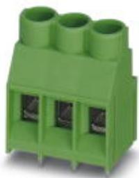
Клеммы для печатной платы, номинальный ток: 32 А, номинальное напряжение: 630 В, размер шага: 6,35 мм, полюсов: 3, тип подключения: Винтовой зажим с натяжной гильзой, монтаж: Пайка волной припоя, направление подключения, проводник/печатная плата: 0 °, цвет: зеленый. Возможна установка в ряд модулей с различным количеством полюсов (контактов)!
