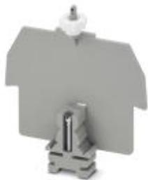
Опорная рейка с возможностью опломбирования, для монтажа на NS 32 и крепления защитного профиля AP 3, с пластиковой гайкой с накаткой M5, толщина: 13 мм
