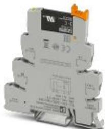
PLC-INTERFACE для функций ввода на PLC logic, с винтовым зажимом и вставным миниатюрным полупроводниковым реле, для монтажной рейки, 1 замыкающий контакт, вход: 24 В пост. тока
