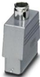
Корпус с кабельным сальником, крепление производится одной защелкой, высота 72 мм, с резьбовым соединением, 1x Pg16, прямое подключение кабеля
