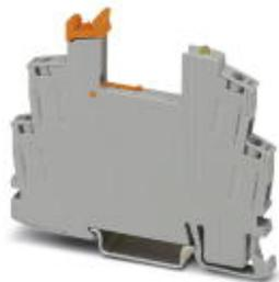
Цоколь реле RIF-0..., для миниатюрных силовых реле с 1 переключающим контактом или полупроводниковым реле аналогичной конструкции, винтовой зажим, для монтажа на NS 35/7,5
