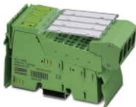
Inline, Клемма аналогового ввода, Аналоговые входы: 8, 0 мА ... 20 мА, 4 мА ... 20 мА, -20 мА ... 20 мА, 0 мА ... 40 мА, -40 мА ... 40 мА, способ подключения: 2-, 3-проводной кабель, скорость передачи данных в локальной шине: 500 кбит/с, встроенный блок питания датчиков, степень защиты: IP20, включая штекеры Inline и поля для маркировки
