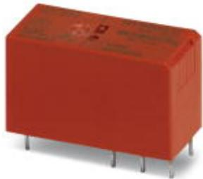
Вставное миниатюрное силовое реле RT III с силовыми контактами, 2 переключателя, входное напряжение: 12 В DC, в сочетании с соответствующим цоколем PLC имеет допуск в соответствии с ATEX/IECEx (зона 2) и зона Ex класс I, разд. 2.
